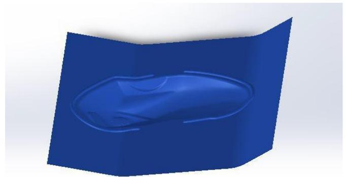
Fig. 2. Die Face Designed in Die Module
